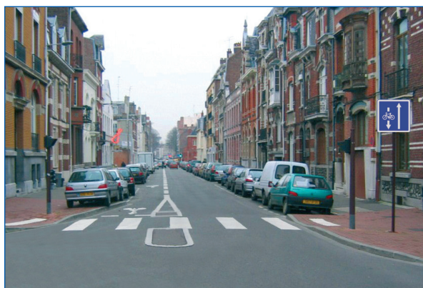
Signalisation de la sortie du double-sens cyclable : horizontale et verticale (C24a). Source : CETE Nord-Picardie
