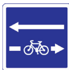
Panneau indiquant la présence de cyclistes dans le sens contraire à la circulation générale pour les usagers d'une voie sécante non prioritaire (C24c)
